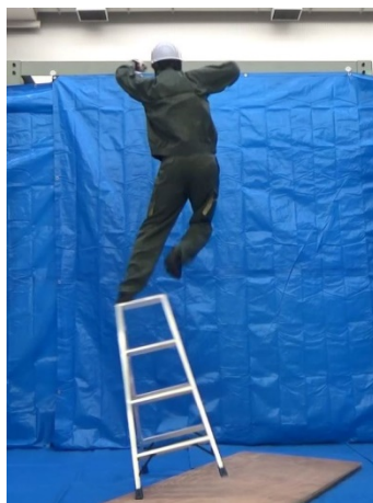
左前側への重心移動により 脚立が傾く様子
