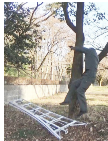
脚立が滑り倒れる様子② (後ろから)
